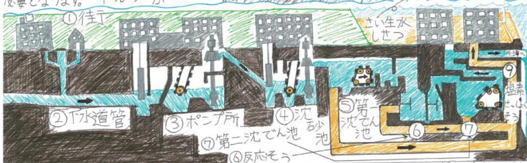
下水道の仕組み
